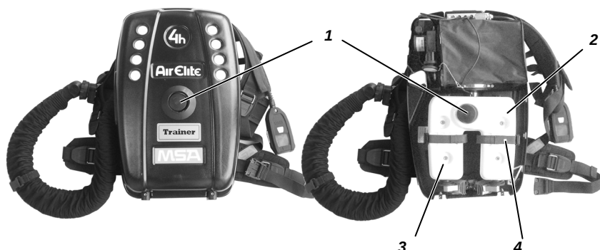
Рис. 6 Дыхательный аппарат с учебной канистрой
